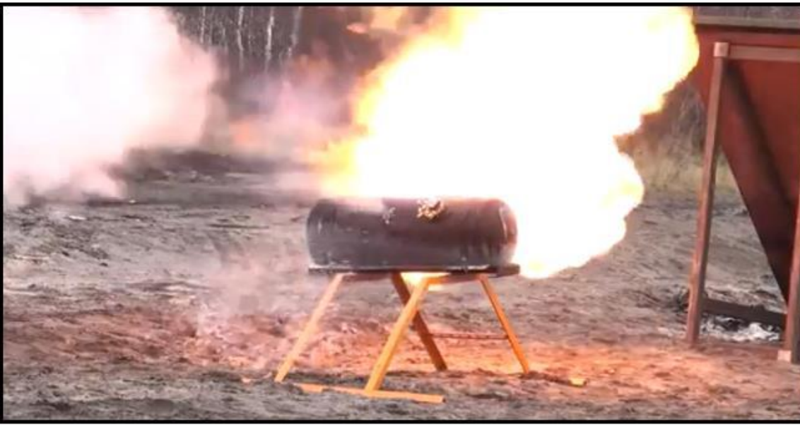
YAPILAN ATIŞ SONRASI ÖN VE ARKA DELİKLERDEN ISININ YÜKSELMESİ VE BASINCIN ARTMASI İLE YÜKSEK HIZLI YANMA
