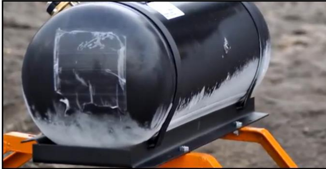
YAPILAN ATIŞ SONUNDA MERMİNİN ÇIKIŞ BÖLGESİ TAHRİBAT 12 MM ÇAPINDA
