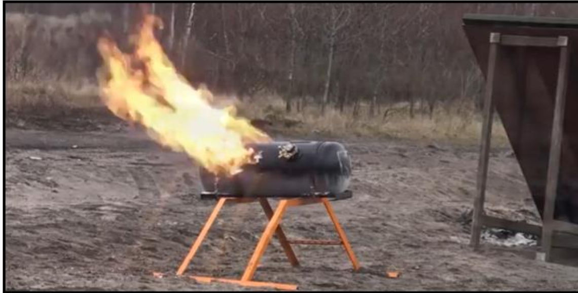
YAPILAN ATIŞ SONUNDA İÇ BASINCIN YAVAŞLAYARAK ALEVLERİN AZALMASI
