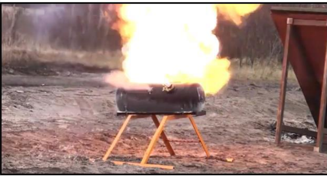
YAPILAN ATIŞ SONRASI ARKA YÜZEYDEDE BAŞLAYAN BASINÇLI ALEVLENME
