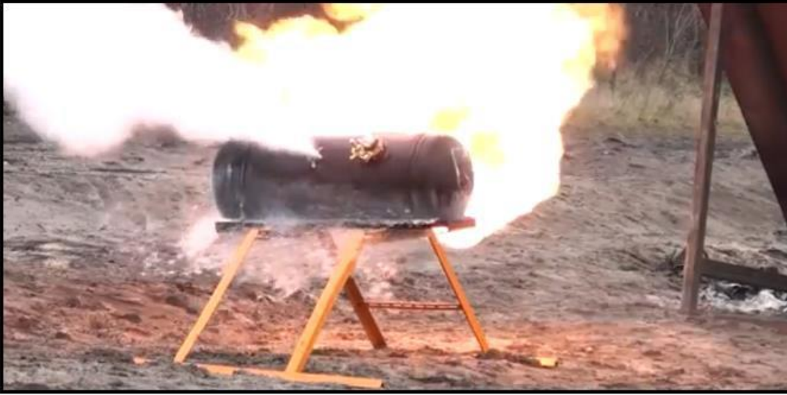
YAPILAN ATIŞ SONRASI DEPO İÇ BASINCININ MAKSİMUM DÜZEYE ULAŞTIĞI NOKTA
