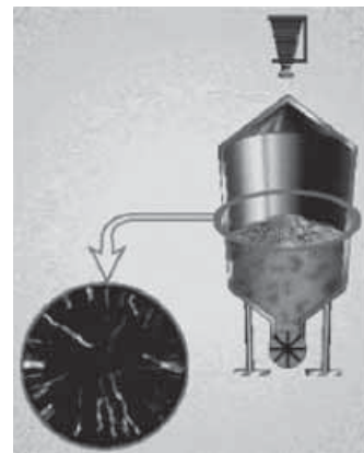
Şekil 4. Siklon ayırıcıda oluşan arklar [4].
