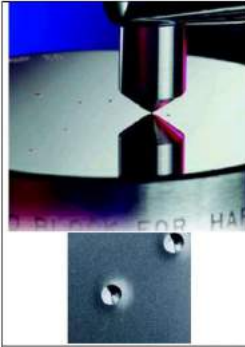
Şekil 1. Rockwell sertlik ölçümü ve prensip şekli
