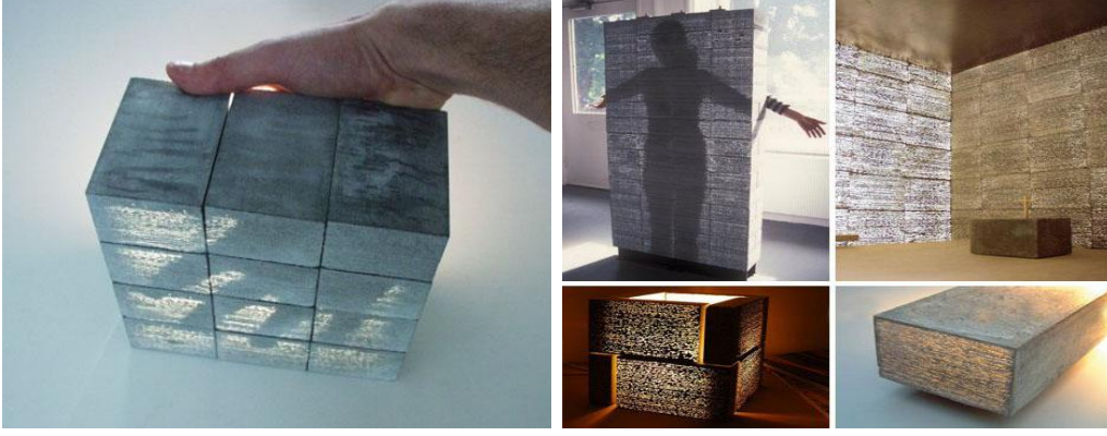
Şekil 2. Saydam betonun ışığı iletmesi
