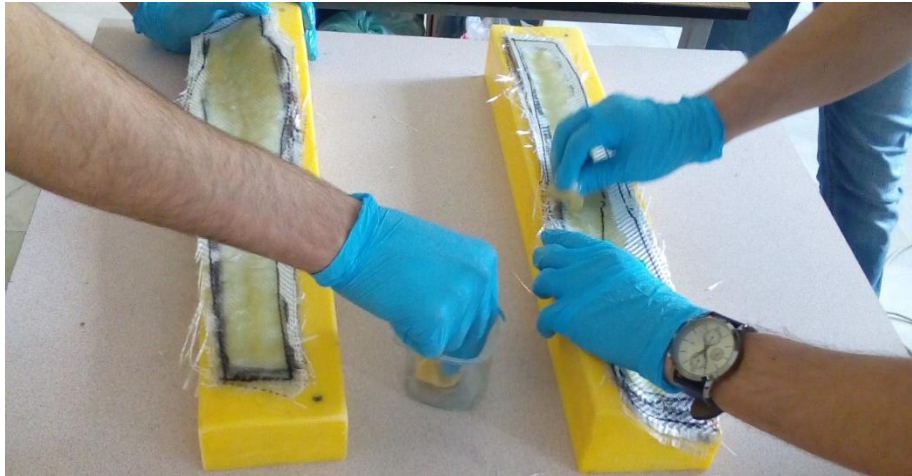
Şekil 10. Cam Elyafın Kalba Serilmesi ve Epoksi Reçinenin Sürülmesi
