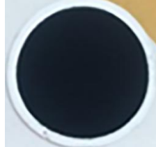
Şekil 1: Vakum filtrasyonu ile elde edilen PANI-KNT%1 kompozit disk örneği
