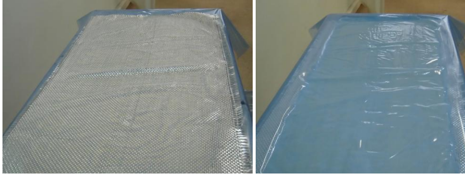
Şekil 2.1. Dokuma SMC pestillerin hazırlanması
