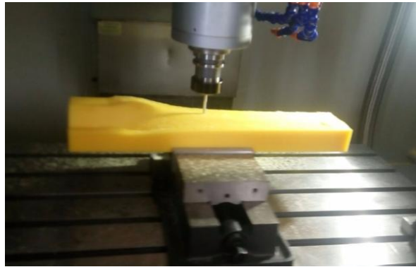
Şekil 7. Kalıp yarımının CNC dik işlem tezgâhında işlenmesi
