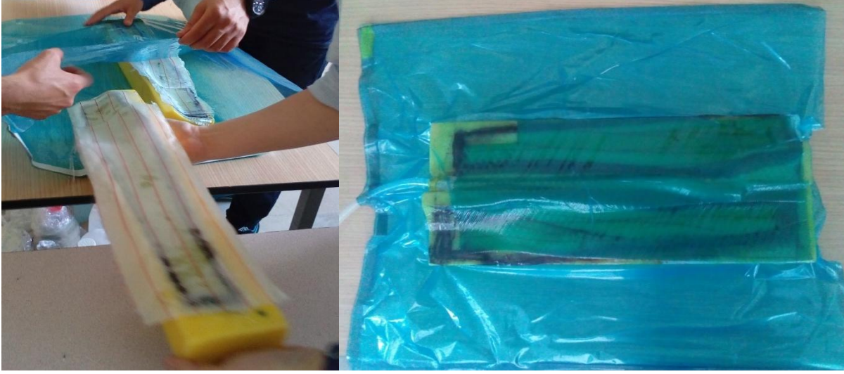
Şekil 11. Kalıbın vakum torbasına yerleştirilmesi ve vakumlanarak bekletilmesi
