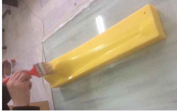
Şekil 8. Kalıp Yüzeyine Kalıp Ayırıcı Sürülmesi
