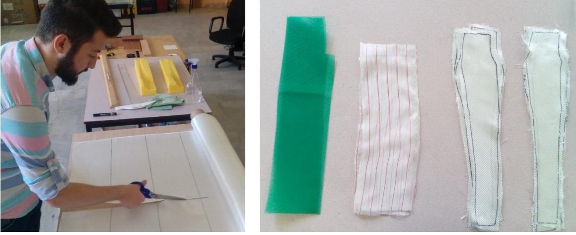
Şekil 9. Cam Elyaf, Soyma Kumaşı ve Reçine Yayılma Ağı Hazırlanması
