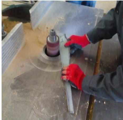
Şekil 12. Kanat Yarımlarının Kesilmesi
