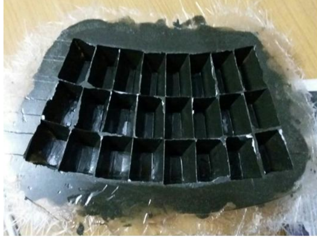
Şekil 4. Model kullanılarak hazırlanan polimer kompozit döküm kalıbı
