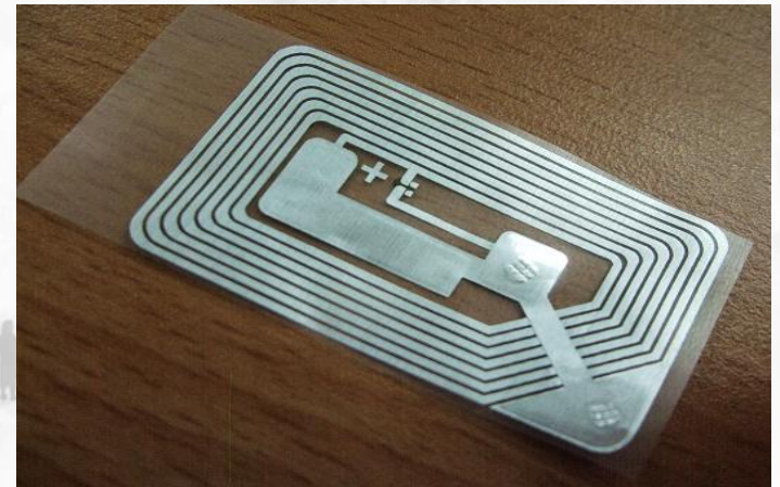
Şekil 2. RFID(radyo frekans tanımlayıcı) etiket yapısı
