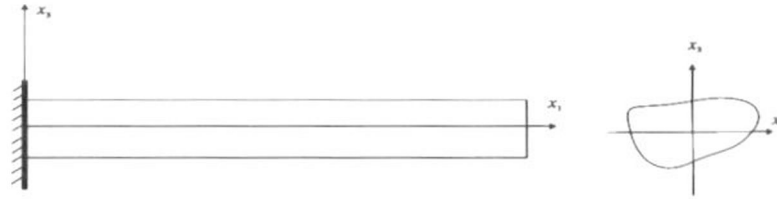
Şekil 1. VABS kiriş koordinat sistemi,[8] / Figure 1. VABS beam coordinate system.[8]
