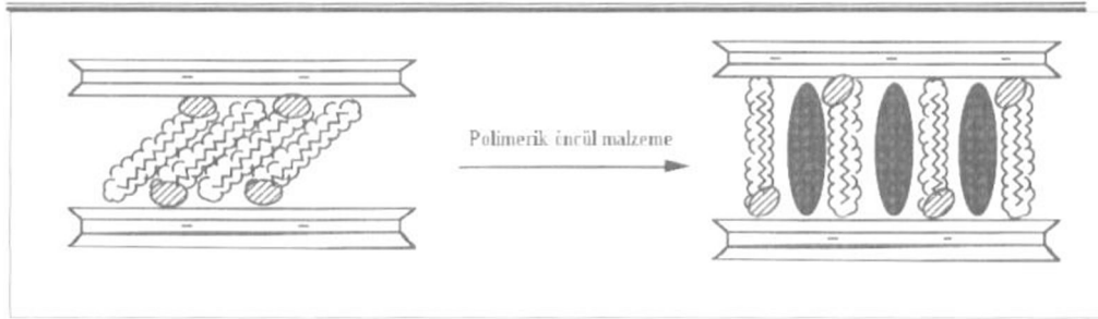
Şekil 2.3.3. Organik olarak modifiye edilmiş killerin polimerik öncül gruplar ile etkileşimi [2].
