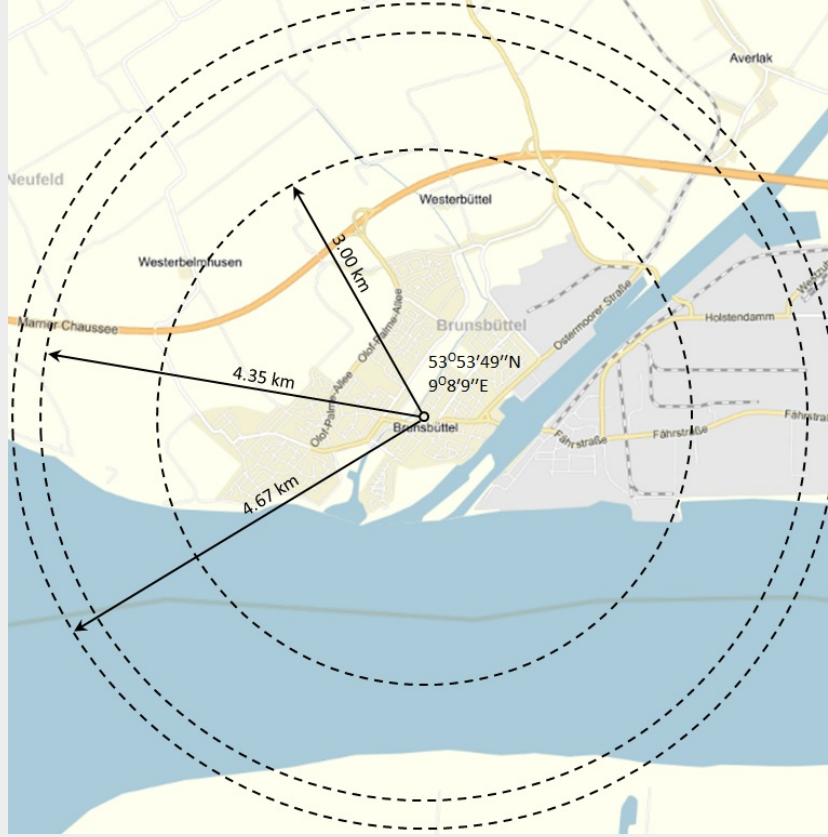
Şekil 2. Örnek uygulamada kullanılan amonyak tankına ait koruma alanları
